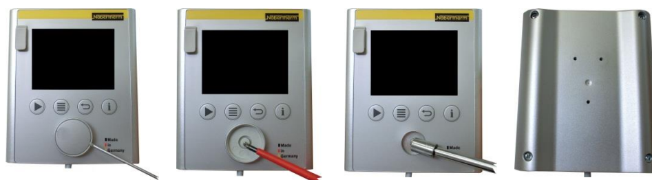
Fig. 12: Demontere styringens kretskort – del 1 (illustrasjon – kan avvike fra faktiske forhold)
