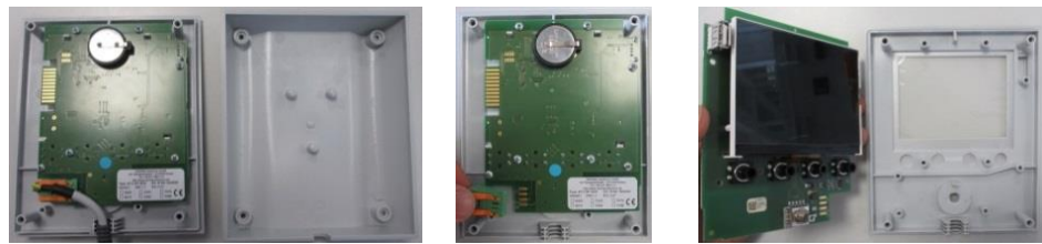
Fig. 13: Demontere styringens kretskort – del 2 (illustrasjon – kan avvike fra faktiske forhold)
